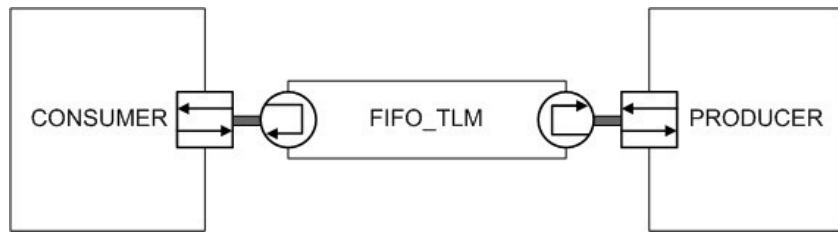
Fig. 3. Sistema de prueba para todos los ejemplos. Los módulos Consumer y Producer pueden ser sintetizados o mapeados indistintamente a HW o a SW.
