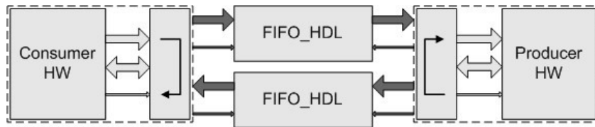
Fig. 4. Sistema con los dos módulos sintetizados a HW, juntamente con las FIFOs. Hemos representado fuera del módulo los wrappers de acceso a las FIFOs.
