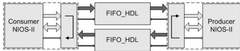
Fig. 6. Los dos módulos están siendo ejecutados por sendos Nios-II usando FIFOs HW reales.
